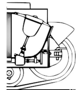
*(Le renfort des roues tendeuses arrière est non perforé sur les côtés pour l'évacuation de l'eau. Sa position, son inclinaison ne sont pas représentées sur le dessin de coupe latérale)*
