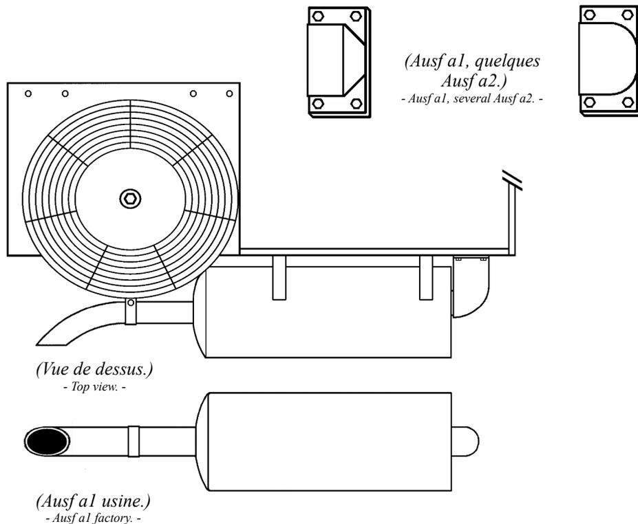
Nota : Les pots d'échappements reposent sur le blindage arrière sur deux supports en arc de cercle. Les croquis d'usine le représente toujours avec une attache au niveau du ventilateur et un collier.
